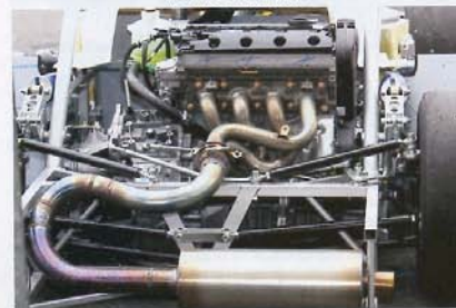
Sous le capot, le bloc moteur est celui de la Peugeot 206 RCC, il développe 190 Ch.
