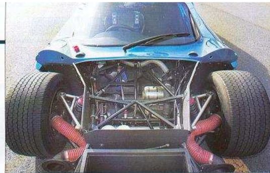
Le capot avant entièrement amovible dégage une excellente accessibilité.
