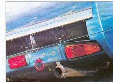
On voit ici que l'alleron arrière est réglable.
