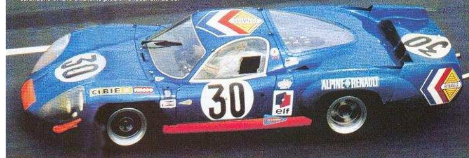
Au Mans en 69, la 1734 n'ira pas plus loin que la 3e heure, pour cause de surchauffe et fuite d'huile: le problème récurrent du V8.
