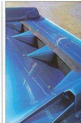
En 1969 est apparue la version affinée avec ces radiateurs disposés à l'extrême arrière.
